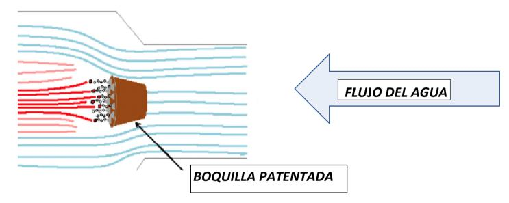
Parte del agua que entra a la cámara se canaliza a boquillas patentadas que convierten agua en vapor de agua
